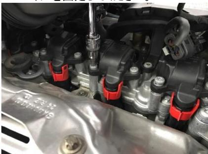
9. グラウンディングケーブル片側をエンジンに接続し、片側をボディのアースポイントに接続してください。
